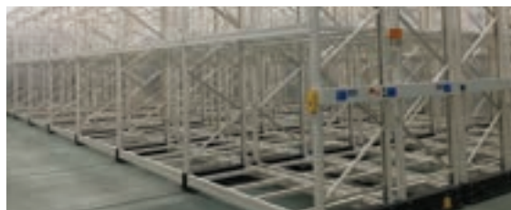
ตัวอย่างการติดตั้งในไทย Mobile Rack ห้องแช่แข็งแบบมีรางนำทาง และแบบไร้ราง
