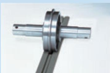
フォークリフトがレール上をスムーズに横断できるように、V溝レールを採用しています。車輪部のフランジとレールが走行時一体となり、ラック移動の斜行を防ぎます。
