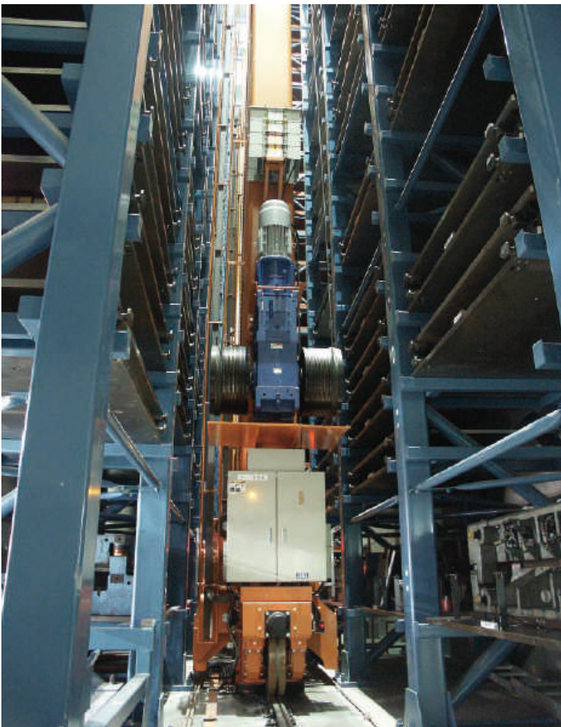
● AS / RS สำหรับการจัดเก็บแม่พิมพ์สำหรับเครื่องเพรส 20,000 ตัน
